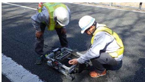
写真-3 透水性試験状況
