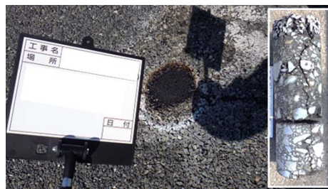
写真-4 コア採取（縦継目）
