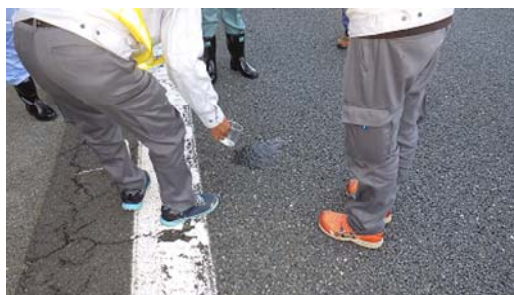
写真-1 簡易透水性試験状況
